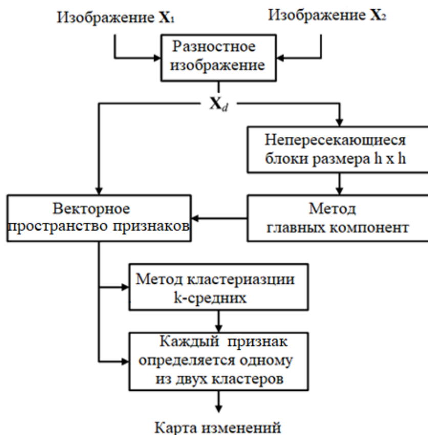
Рисунок 2.1 – Схема работы метода анализа главных компонент и К-средних
