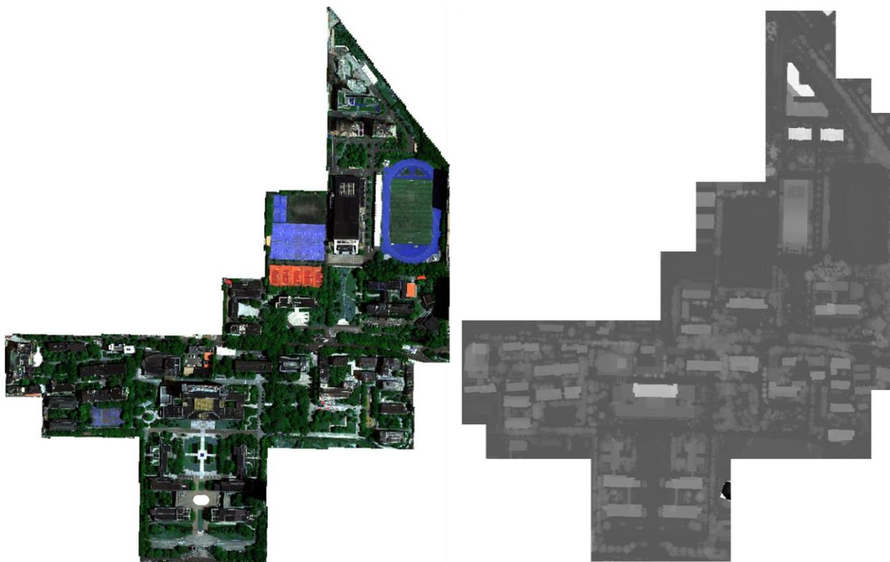
Рисунок 2.2 – Ортофотоплан (слева) и карта высот (справа)
