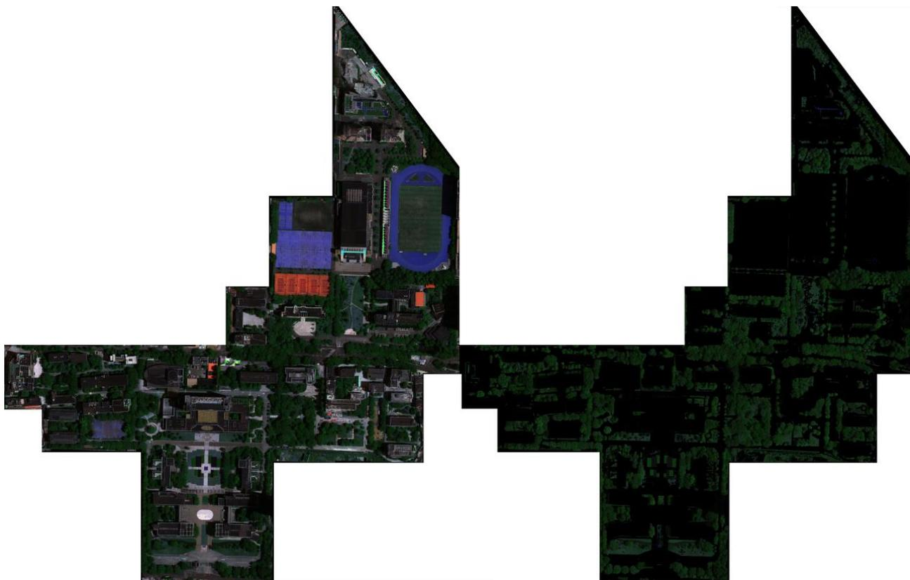
**Рисунок 2.6 – Результат выделения растительности (справа) на основе вегетационного индекса NDVI**
