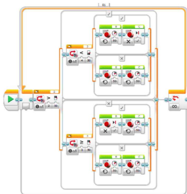
Рисунок 1.3 – Алгоритм демонстрирующий работу на двух цветных датчиках
