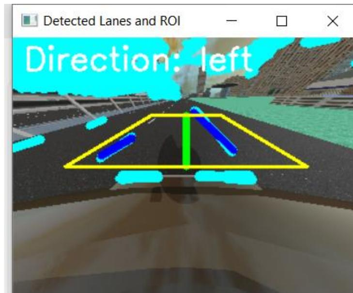
**Рисунок 1.5 — Область интереса (ROI), центральная линия, линии Хафа, две направляющие линии текущей полосы**
