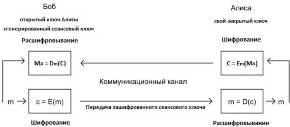
Рисунок 1.4 – Схема алгоритма RSA с использованием сеансового ключа
