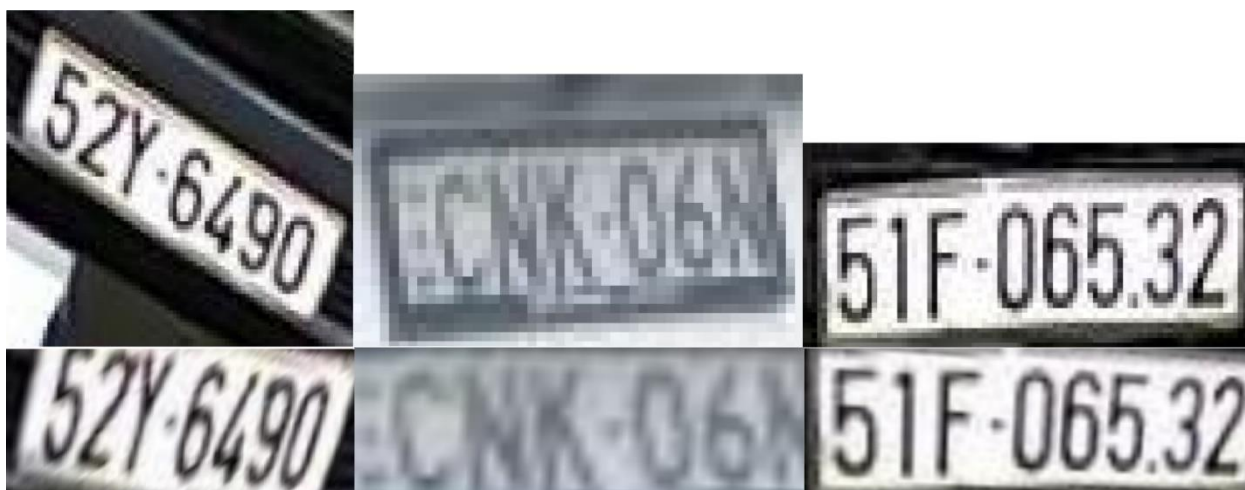
Рисунок 3.3 – Пример использования алгоритма нормализации
