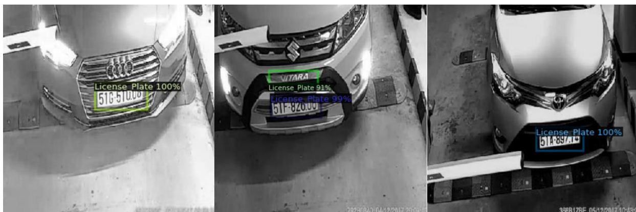
Рисунок 3.2 – Пример обнаружения сетью Faster R-CNN
