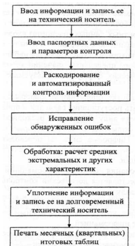
Рисунок 24. - Блок-схема первого этапа обработки режимной информации
