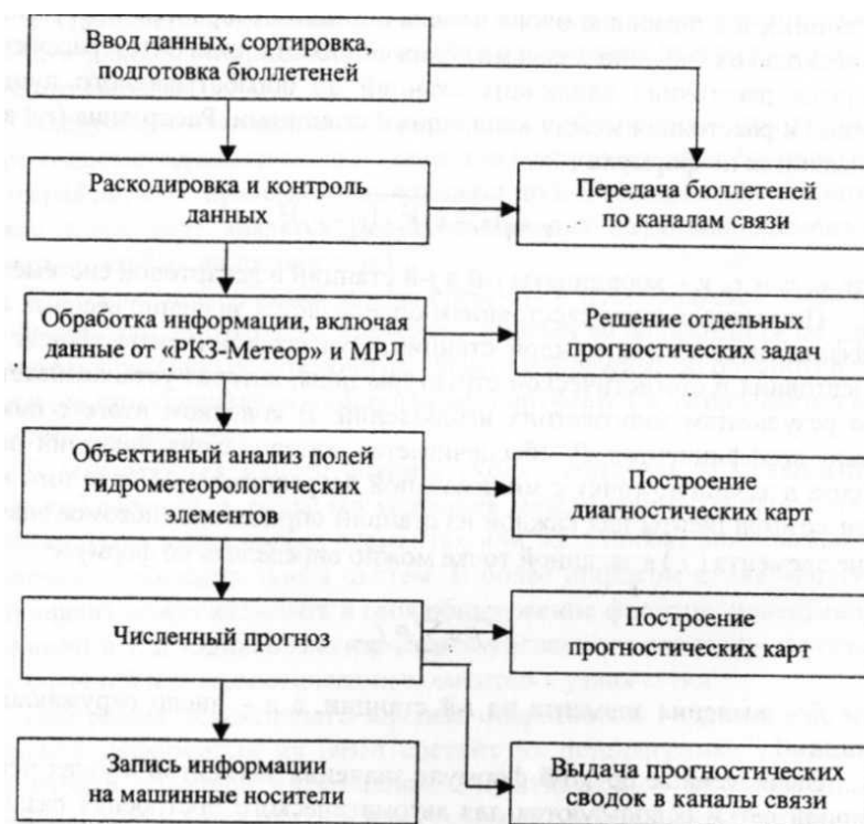
Рисунок 23. - Блок-схема автоматизированной обработки оперативной гидрометеорологической информации
