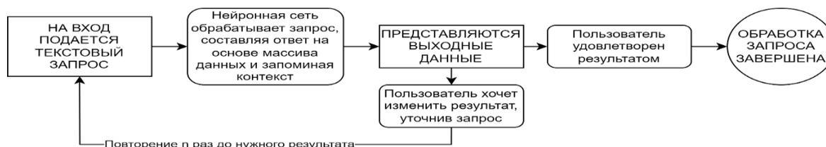
Рис. 2. Принцип работы языковой генеративной модели нейронной сети
