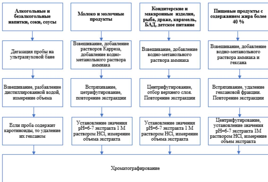
**Рисунок 7 – Схема определения красителей хроматографическим методом**
