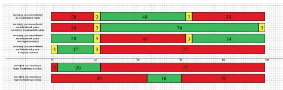
Рис. 3. График работы светофоров после оптимизации
