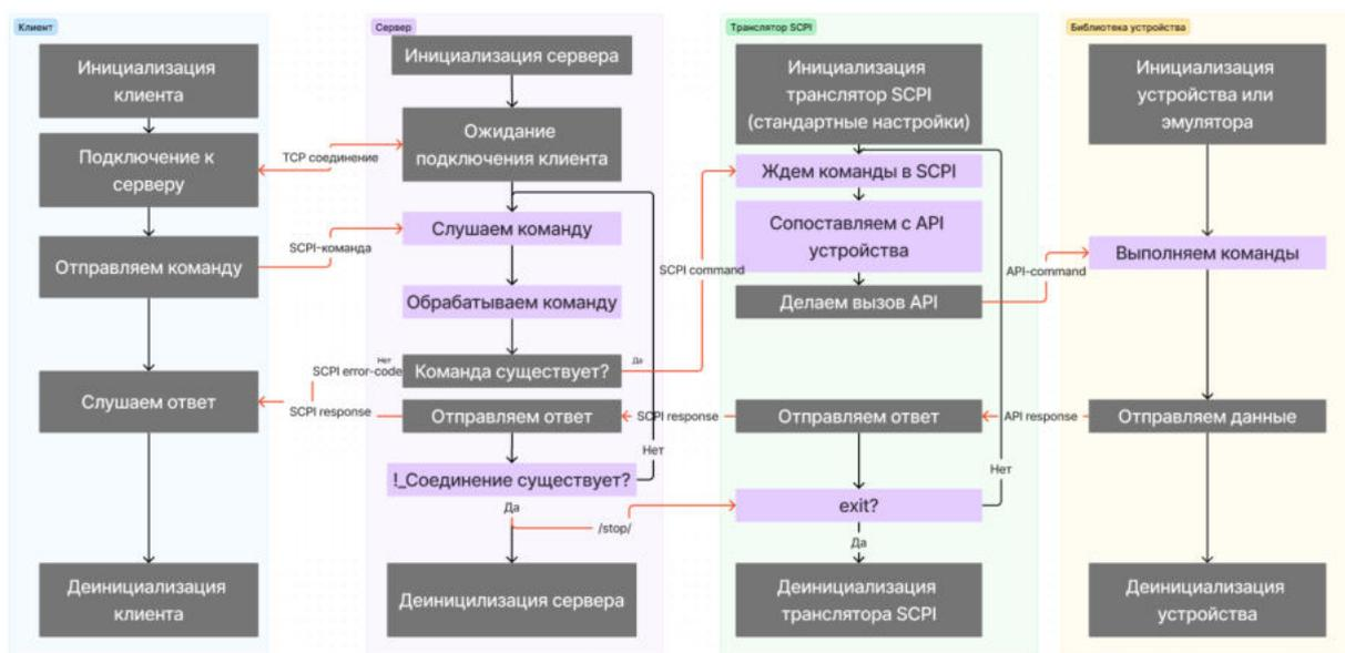
Рис. 2. Блок-схема проекта
