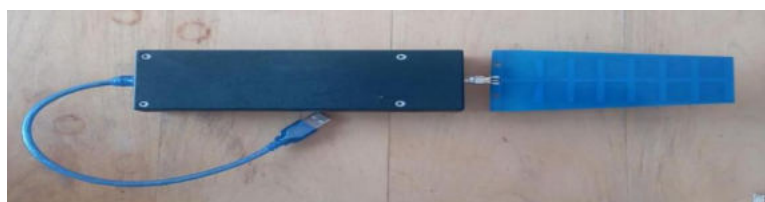
Рис. 2. Изображение приёмопередающего зонда
