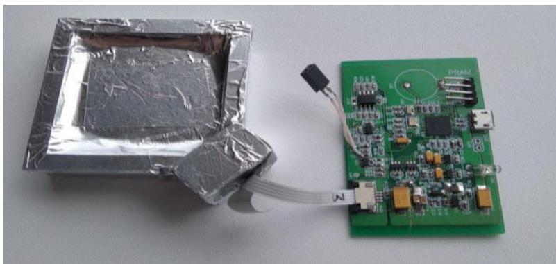
Рис. 1. Устройство для измерения излучения
