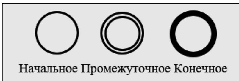
**Рисунок 13** – Графические элементы простых Событий
