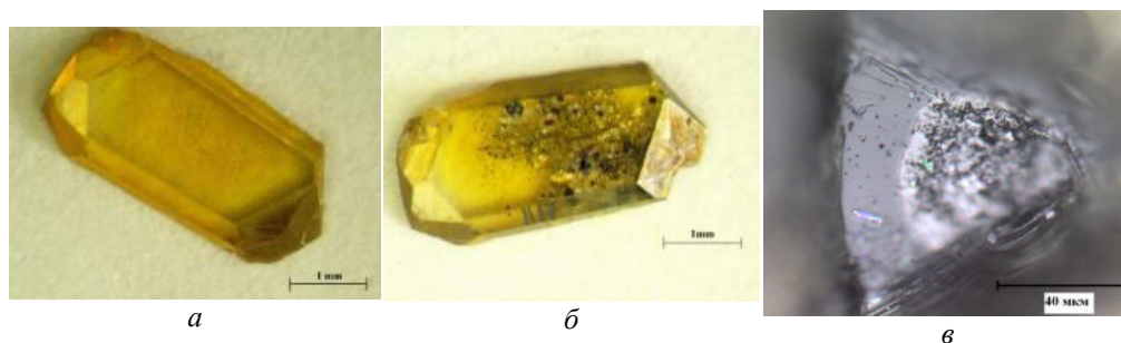
Рис. 1. Оптические изображения поверхности НРНТ-алмаза: а – исходный образец; б – образец после воздействия лазерного импульса со средней плотностью энергии 7,6 \text{ Дж/см}^2 ; в – локальная область, в которой наблюдается образование графита
