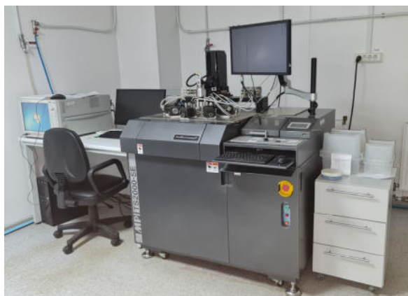
Рис. 2. Измерительный комплекс вольт-амперных и вольт-фарадных характеристик Keysight B1500A Semiconductor Device Analyzer с зондовой станцией MPI TS2000-SE (США)
