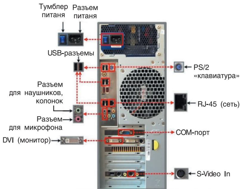
Рис. 63. Разъемы в системном блоке компьютера
