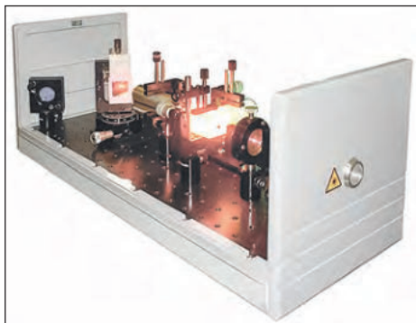
Рис. 14. Лазер на красителе с дисперсионным резонатором
