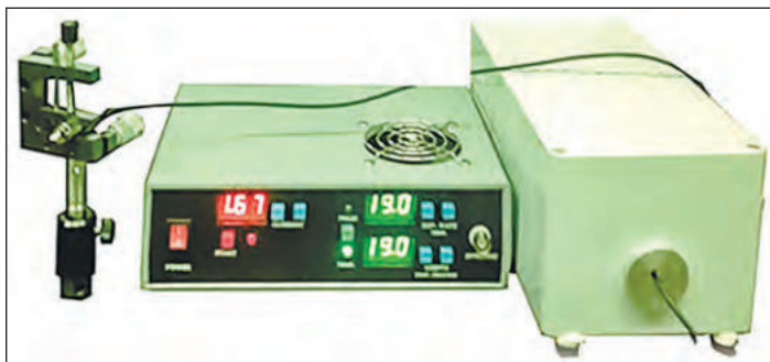
Рис. 17. Лазерный диод накачки с блоком управления
