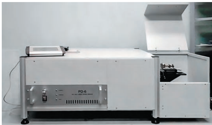
Рис. 21. Лазерный атомно-эмиссионный спектрометр
