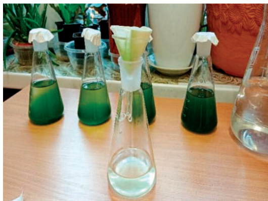
Рисунок 3 – Фильтрация суспензии Chlorella vulgaris
