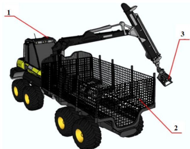
1 – базовая машина; 2 – модернизированный прицеп; 3 – грейферный захват с гильотинным ножом
