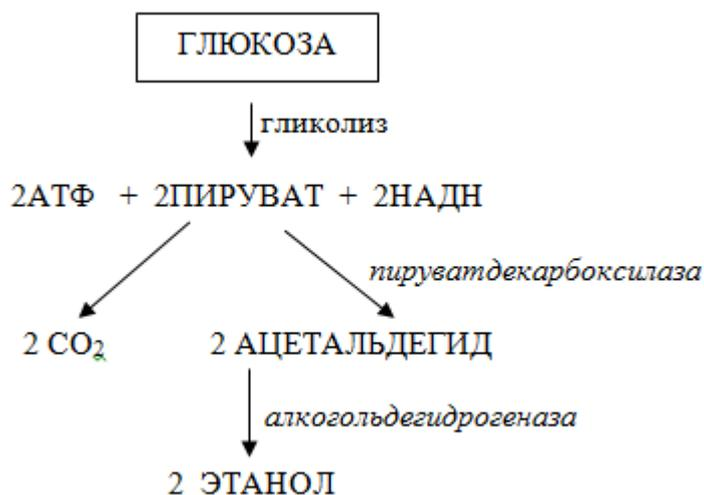
Рисунок 21 – Схема спиртового брожения у дрожжей
