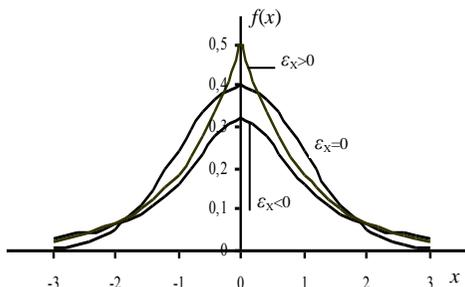
Рис. 4.18. Плотности распределения с различными эксцессами
