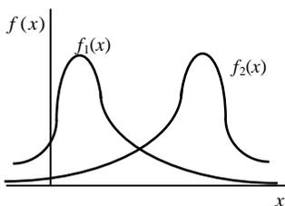
Рис. 4.17. Плотности распределения с различными коэффициентами асимметрии
