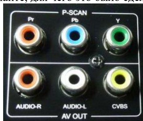
Рисунок 27 – Использование цвета для штекеров и гнезд.
