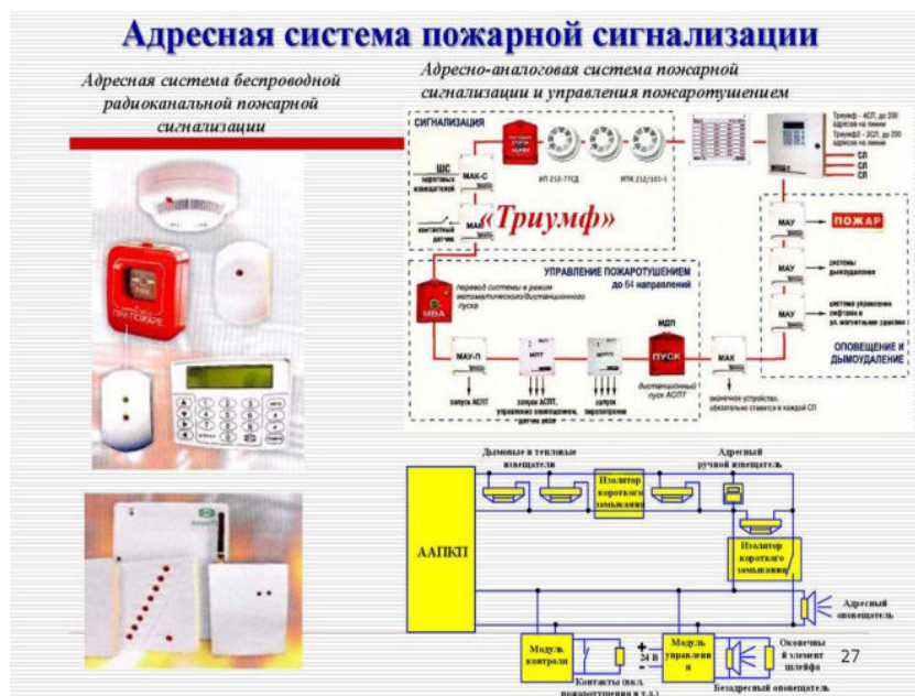
Рисунок 1 – Адресная система пожарной сигнализации
