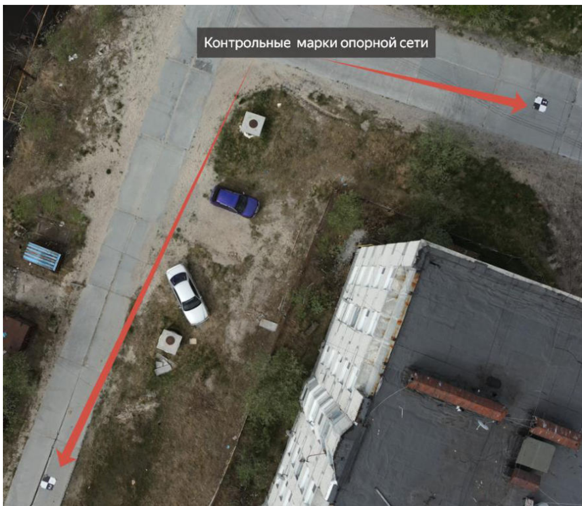
Рис. 2. Пример выставленных опознаков № 1 и № 2, вид сверху
