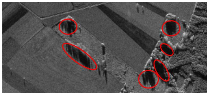
Рисунок 45 – Эффекты, возникающие на радарных снимках обусловленные геометрией съемки и рельефом местности
