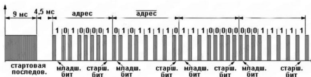
Рис. 2 Структура пакета протокола NEC
