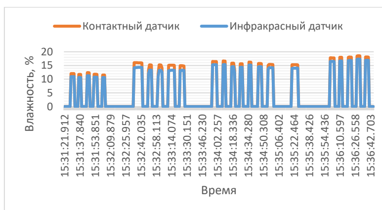
Рис. 5. График зависимости влажности зерна от времени при измерении по одному параметру при высокой температуре зерна
