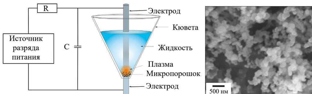
Рис. 1. Схема экспериментальной установки и СЭМ-изображение исходных частиц кремния
