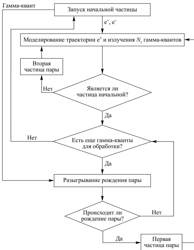
Рис. 1. Блок-схема алгоритма моделирования электромагнитного ливня
