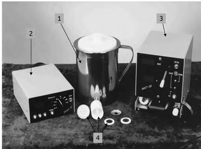
Рис. 1. Фотография прибора для травления трековых детекторов – термостат ТРАЛ-1 (1 – травильное устройство; 2 – электронный блок), а также аппарата для автоматического искрового счета треков АИСТ-2В (3) и радонометра (4)
