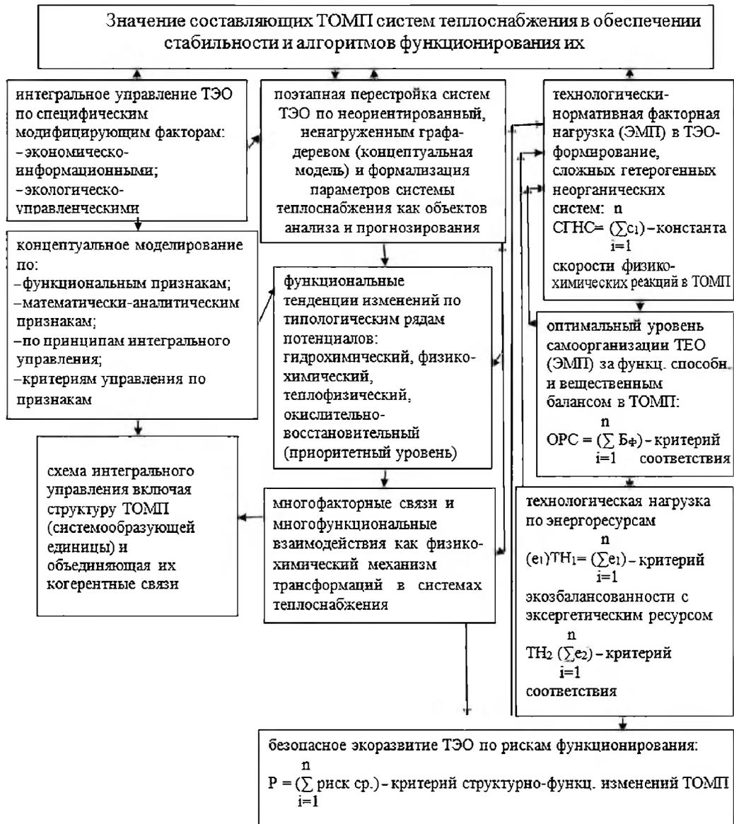
Рис. 1. Характеристика взаимодействий в системе ТЭО с учетом прямых и обратных связей
