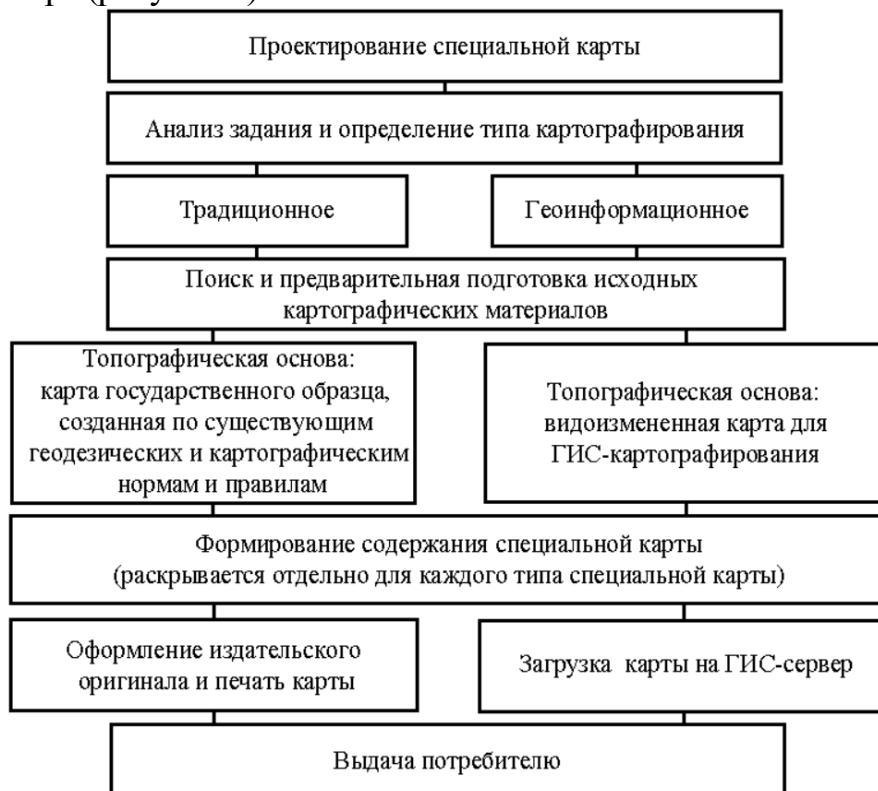
Рисунок 2 – Сравнительная методика проектирования специальных карт, используемых в ВС Республики Беларусь, для традиционного и геоинформационного картографирования
