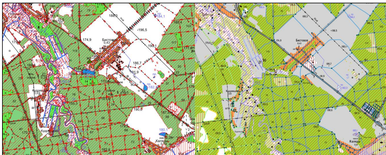
Рисунок 6 – Фрагменты цифровых специальных карт условий проходимости масштаба 1:50 000 номенклатуры N-35-069-Б (картографическая основа – Госкомимущество Республики Беларусь), созданные с применением традиционного (а) и геоинформационного (б) подходов
