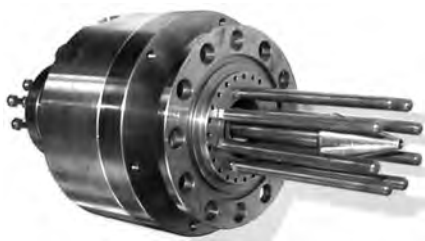
Рис. 9.1. Разрядное устройство магнитоплазменного компрессора (а) и кинокадр свечения КПП (б)
