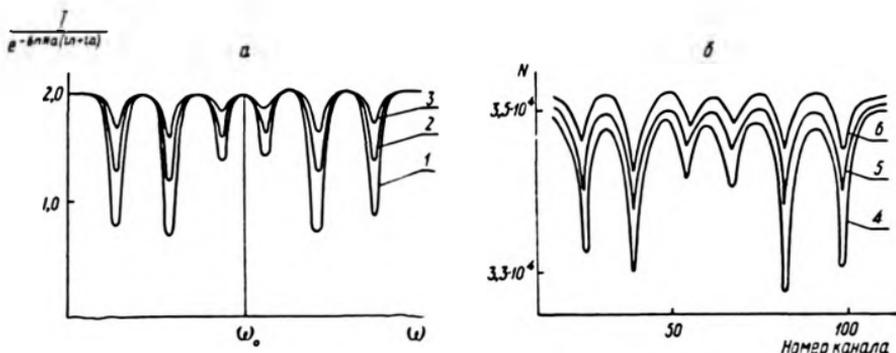
Рис. 3. Частотные зависимости интенсивности  $\gamma$ -излучения, прошедшего через систему поляризатор — анализатор для углов  $\theta = 0^\circ, 45^\circ, 90^\circ$  (а — теоретические, б — экспериментальные)
