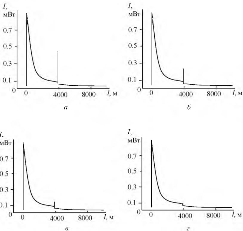
Рис. 3. Зависимость сигнала обратного рассеяния для волоконного световода с разрывом при  $S_{\text{отр}} = 0.5(a), 0.3(б), 0.1(в), 0.01(г)$
