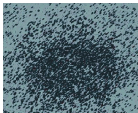
Рис. 8. Фотография подложки, напыленной селективно созданным фотоионным пучком индия
