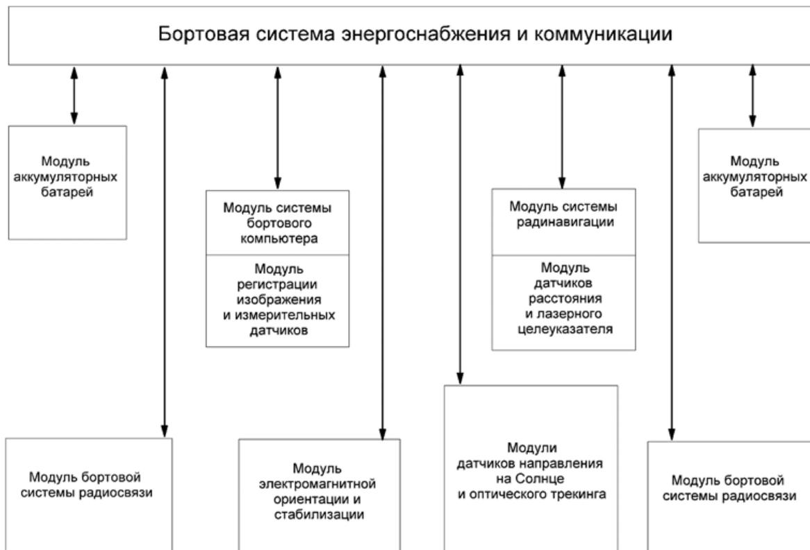
Рис. 1. Структурная схема инженерной модели сверхмалого космического аппарата
