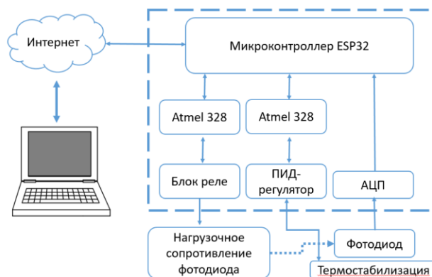
Рис. 2. Структурная схема измерителя
