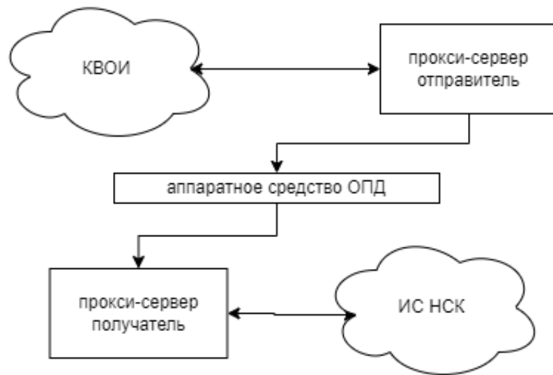
Рис. 2. Модель ОПД на основе прокси-серверов
