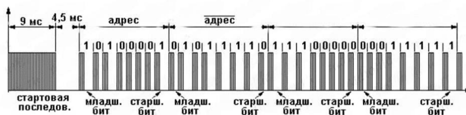
Рис. 2. Структура пакета протокола NEC
