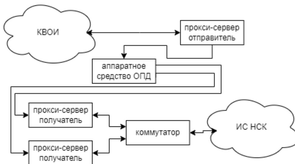
Рис. 3. Третья модель однонаправленной передачи данных
