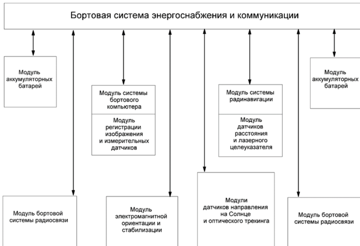
Рис. 1. Структурная схема инженерной модели сверхмалого космического аппарата
