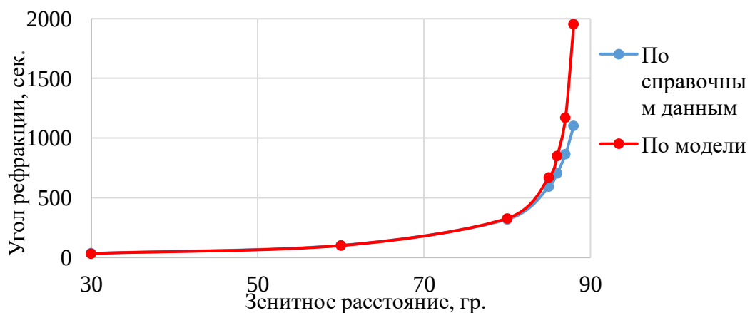
Рис. 2. Графики зависимости угла рефракции (в секундах) от зенитного угла
