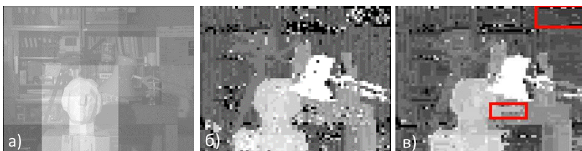
Рис. 2. а) Визуализация порогов по сегментам (чем выше порог, тем ярче цвет прямоугольника); б) карта глубины полученная классическим SAD , в) полученная модифицированным методом SAD
