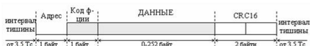
Рис. 1. Формат кадра Modbus RTU
