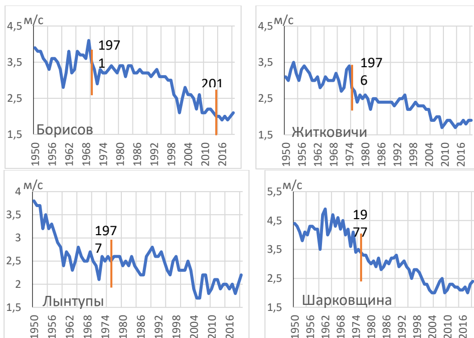
Рис. 2. Графики средней годовой скорости ветра за период с 1950 г. по 2020 г. на метеостанциях Борисов, Житковичи, Лынтупы, Шарковщина. Линиями красного цвета отмечены года смены основного прибора для наблюдений за ветром
