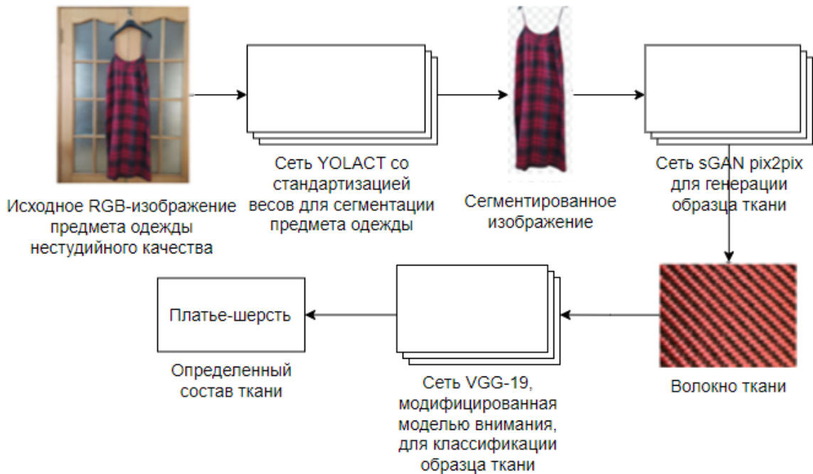
Рисунок 7 – Схема последовательности блоков алгоритма
