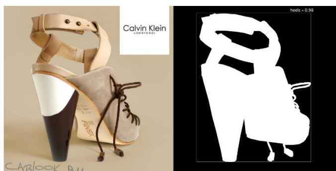
Рисунок 3 – Результат работы алгоритма по сегментации изображений электронной коммерции
