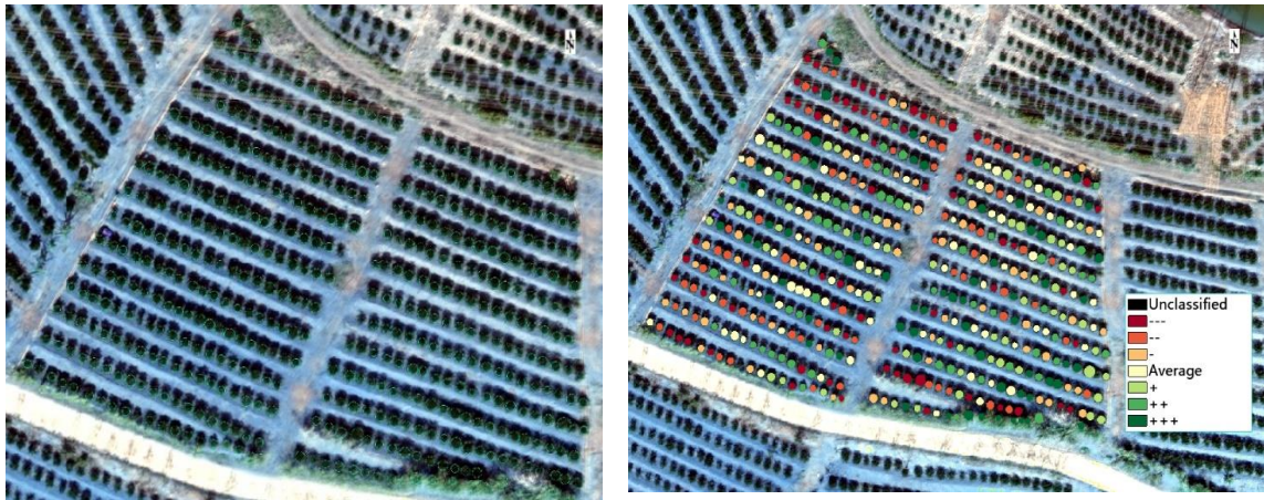
Рис. 5. Экспорт и полный анализ состояния здоровья растений: красно-коричневым отмечены 3 степени заболеваемости садовых деревьев; зеленым – степени здоровых садовых деревьев (выполнено Жун С.)
