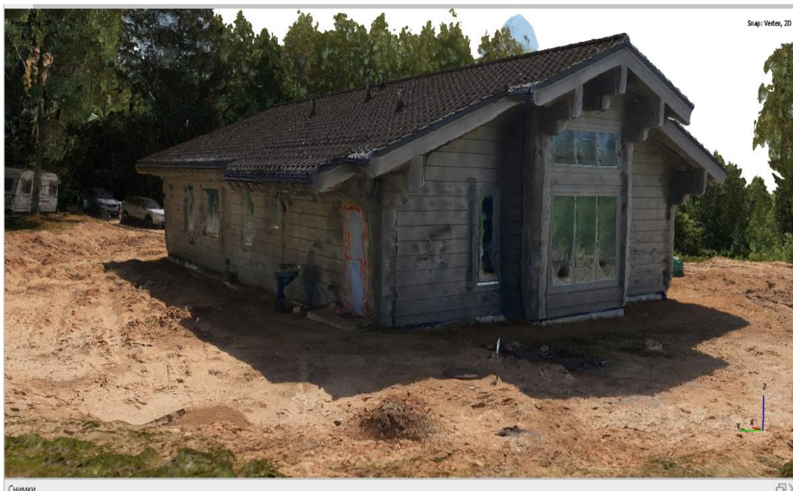
Рис. 3. Фрагмент построения тайловой модели жилого здания на основе комплексной съемки
