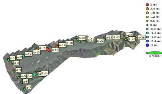
Рис.4. Положение опорных и контрольных точек и оценка погрешности
