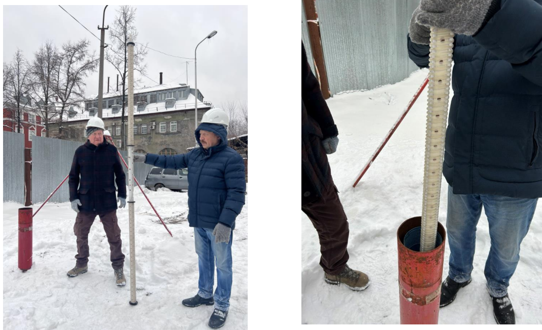
Рис. 1. Опытный образец многоканального скважинного иньектора
