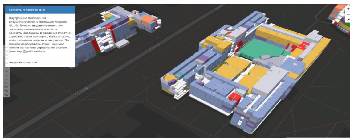
Рис. 2. 3D-модель визуализации внутренних помещений с помощью Mapbox GL JS, комнаты окрашены в зависимости от их функции [6]
