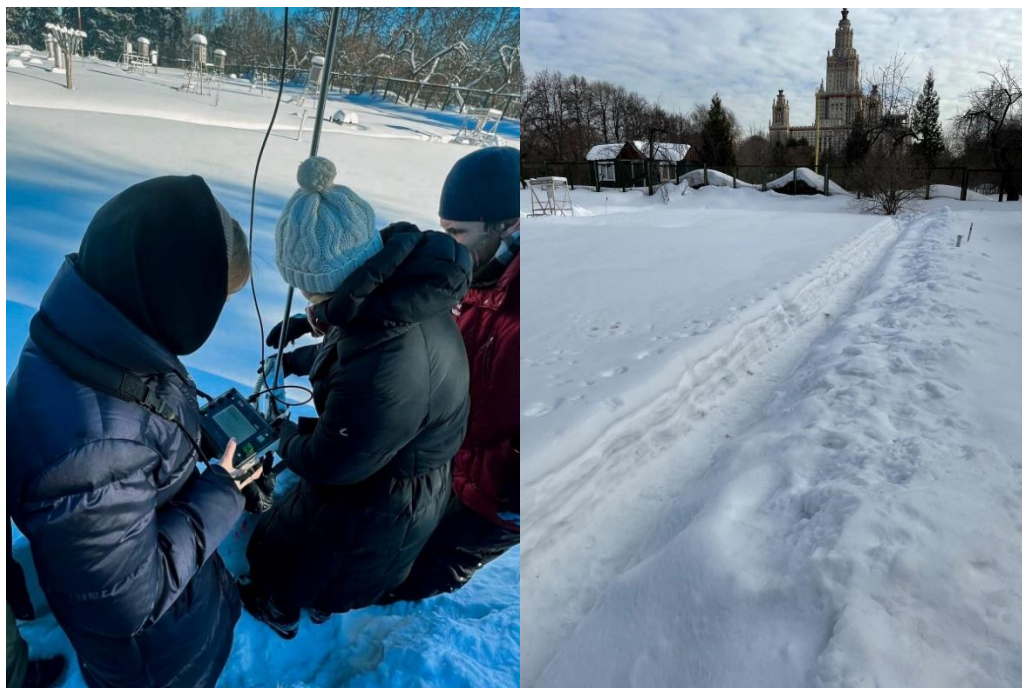
Рис. 3. Изучение пространственной неоднородности строения и толщины снежной толщи при помощи прибора микротвердомера snow micro rep.
