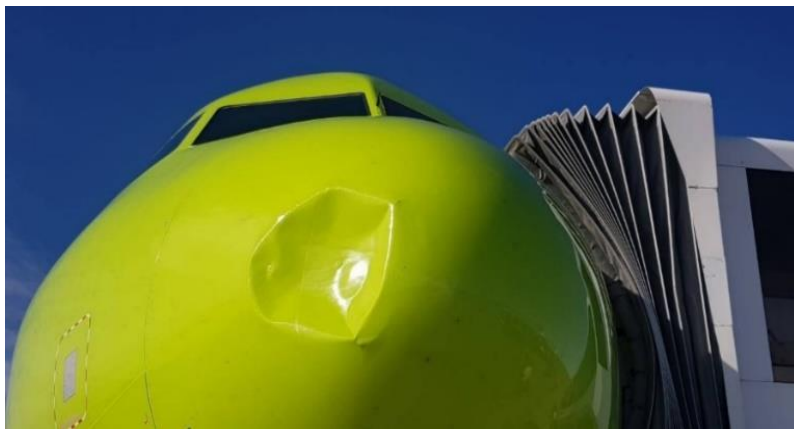
Рис. 1. Пример последствий столкновения самолета Airbus A320neo с чайкой в аэропорту Анадырь («Угольный») имени Ю. С. Рытхэу
