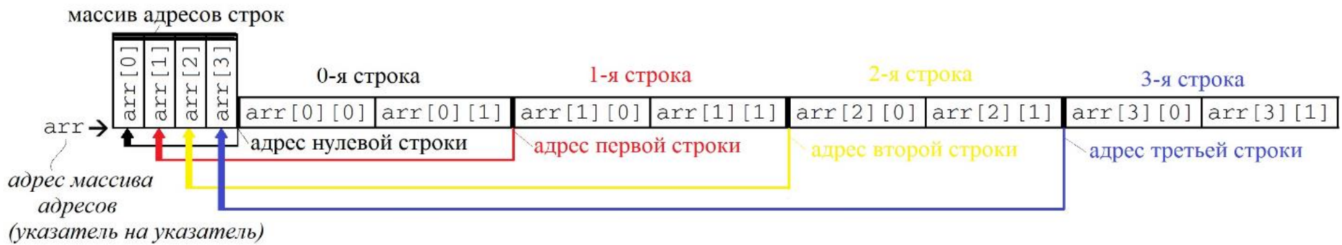
Рисунок 22 – Схема хранения в памяти двумерного массива
