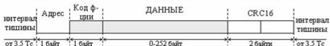
Рис. 1. Формат кадра Modbus RTU
